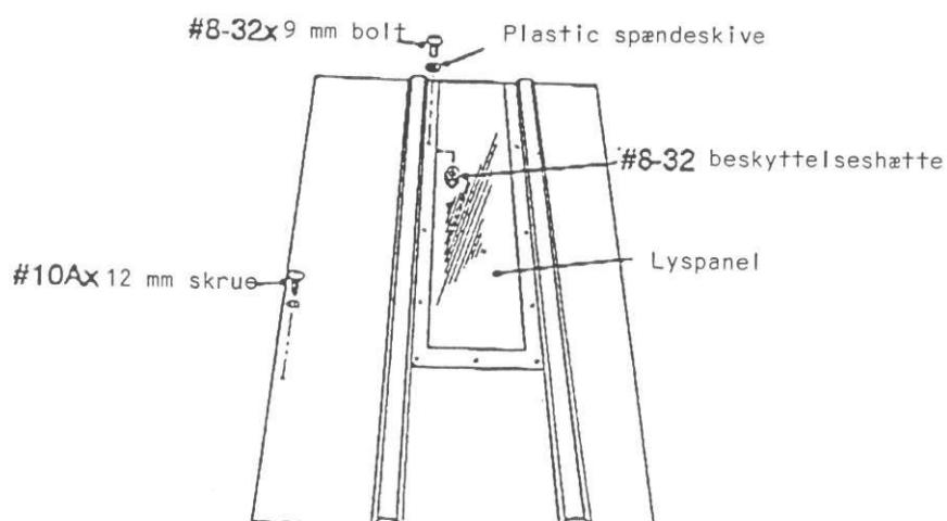
TRIN 4. Anbring det nye samlede lyspanel på tagspærene og fastgør med bolte, spændeskiver og møtrikker. Brug medlevrede #10A x 12 mm skruer i dette sæt til at erstatte skruer.
