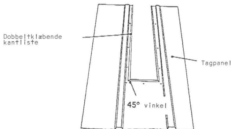
TRIN 3. Monter lyspanelet på ydersiden af tagpanelet ved hjælp af #8-32 9 mm bolte, spændeskiver og #8-32 beskyttelseshætter leveret med lyspanelet. **NB!** Vent med at montere bolte i de huller i panelet, hvor hullerne skal anvendes til montage i tagspæret (2 øverste huller).
